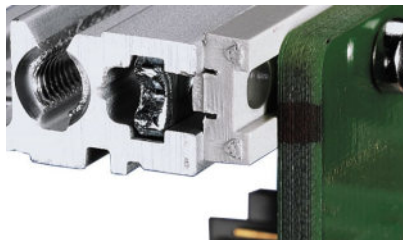
Монтаж объединительной платы с изолирующей планкой
